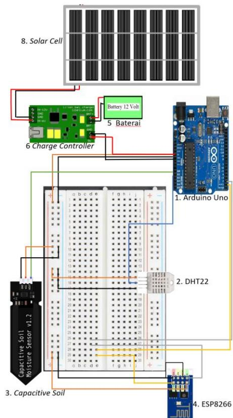
Gambar 2. Perancangan Alat dan Komponen
