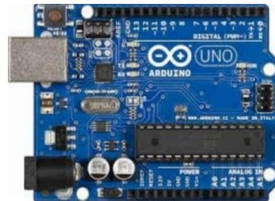
Gambar 1. Tampilan fisik Arduino Uno R3
