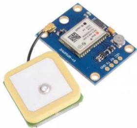
Gambar 3. Bentuk fisik GPS uBlox Neo 6M
