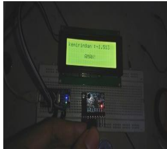
Gambar 9. Implementasi pada Arduino dengan status aman
