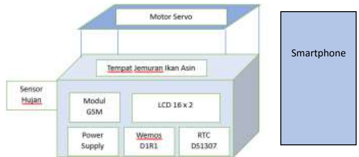
Gambar 4. Rancangan Alat Jemuran Ikan Asin Otomatis
