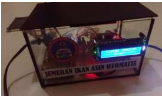
Gambar 6. Bentuk Fisik Alat Jemuran Ikan Asin Otomatis
