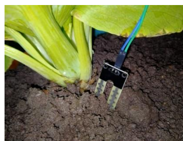
Gambar 11. Bentuk pengujian sensor soil moisture
